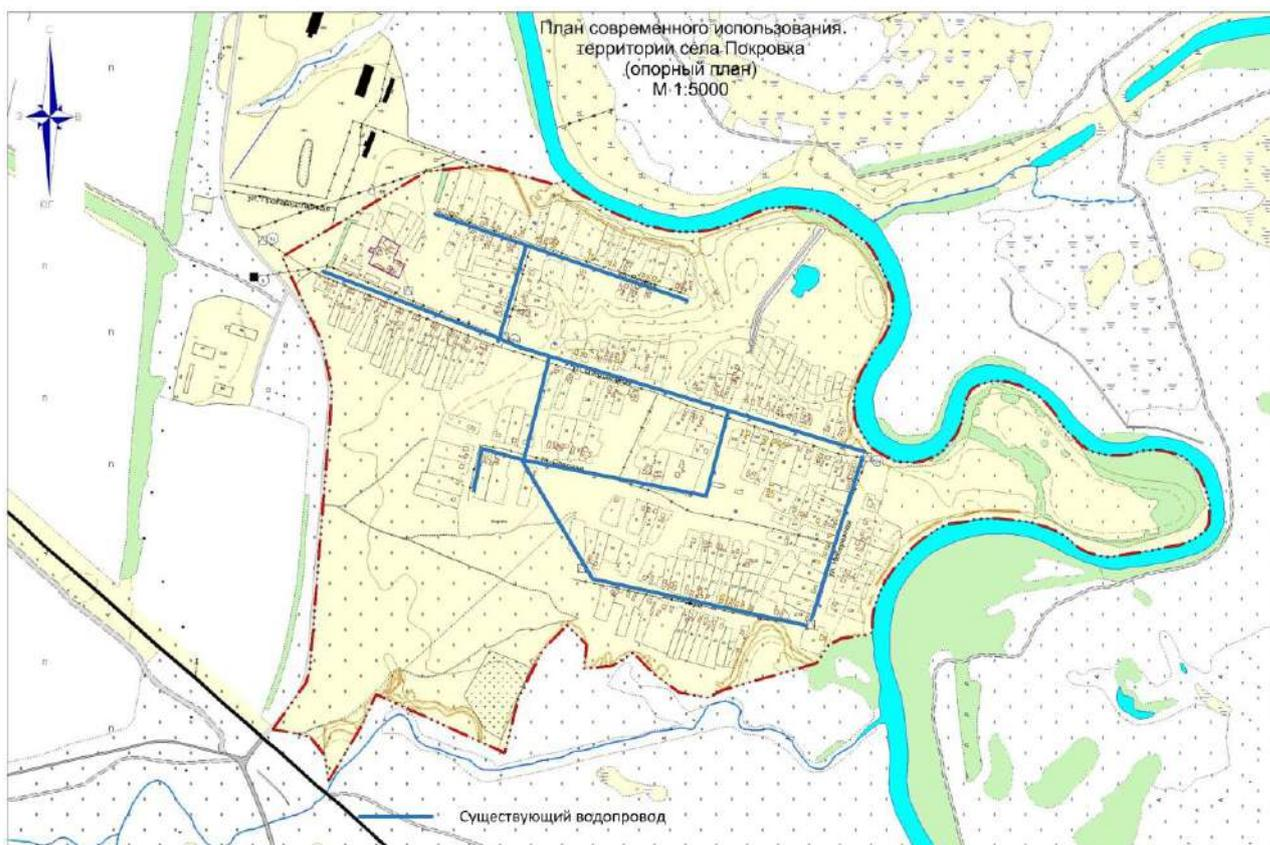
Рис. 2.2.2 - План существующей системы водоснабжения с. Покровка
