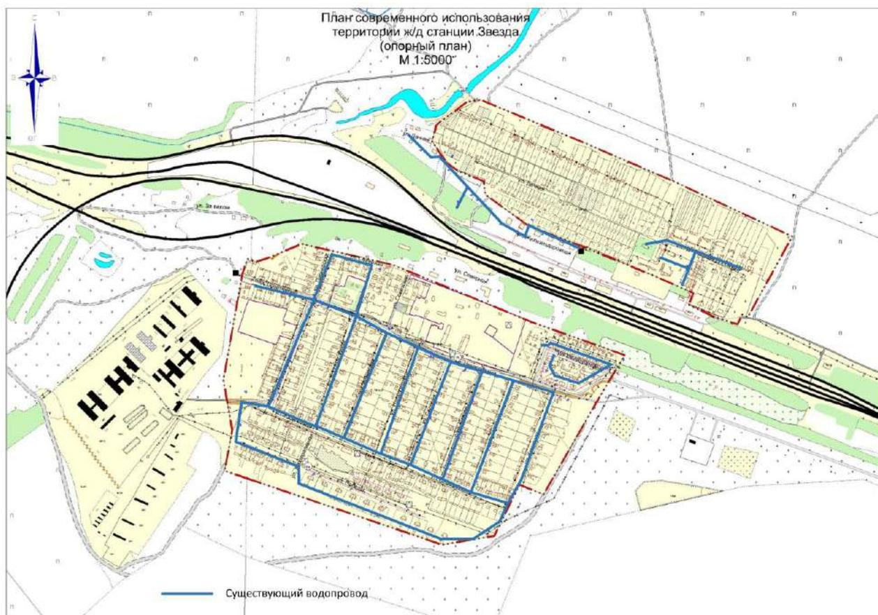
Рис.2.2.1 – План существующей системы водоснабжения ж/д. ст. Звезда
